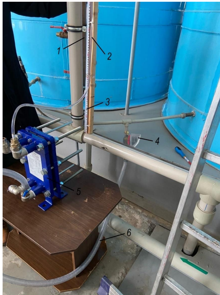
Рисунок 5.4 – Общий вид экспериментальной установки по исследованию потерь напора:
