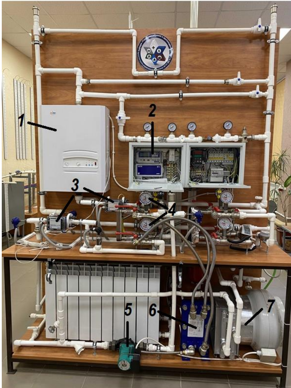
Рисунок 4.2 - Лабораторная установка «Независимая система отопления жилого здания»:
